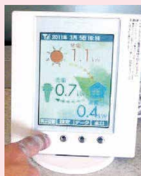
発電モニターには発電量や消費電力が表示されます。省エネにチャレンジ!!
