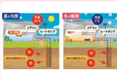
地中の温度は季節に関係なく約15℃～20℃に保たれているので、夏は冷房、冬は暖房として利用することができます。 (SAGA サンライズパーク)
