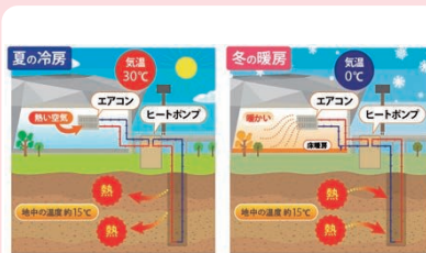
地中の温度は季節に関係なく約15℃～20℃に保たれているので、夏は冷房、冬は暖房として利用することができます。 (SAGA サンライズパーク)
