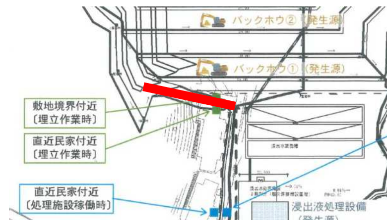
防音壁の設置位置
