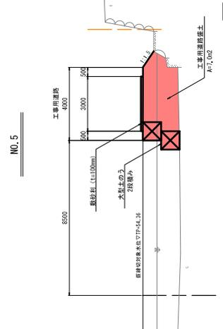
下流側施工時 仮締切断面図 S=1:100
