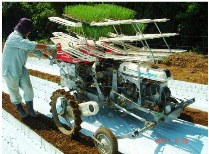
図5 新育苗法により可能となった全自動機械移植
