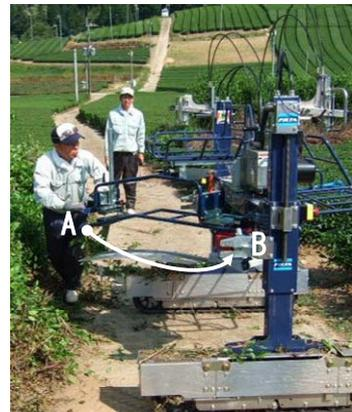
注) 作業機の片端をA点からB点へ矢印のように反転させる。
