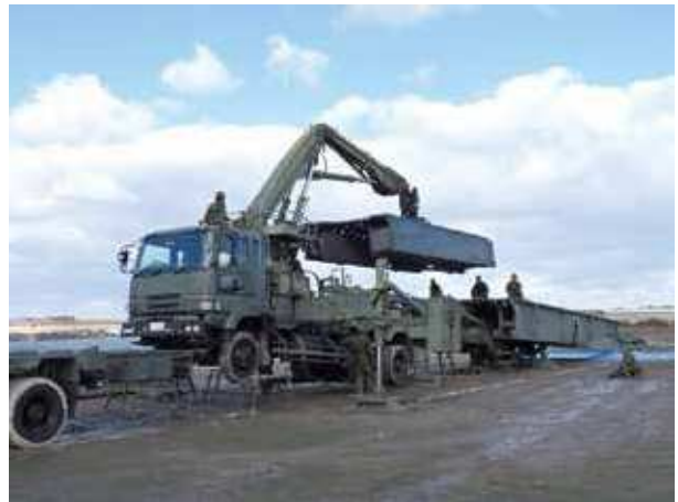
道路啓開訓練 (自衛隊による架橋設置の様子) (於：松浦川運動広場)
