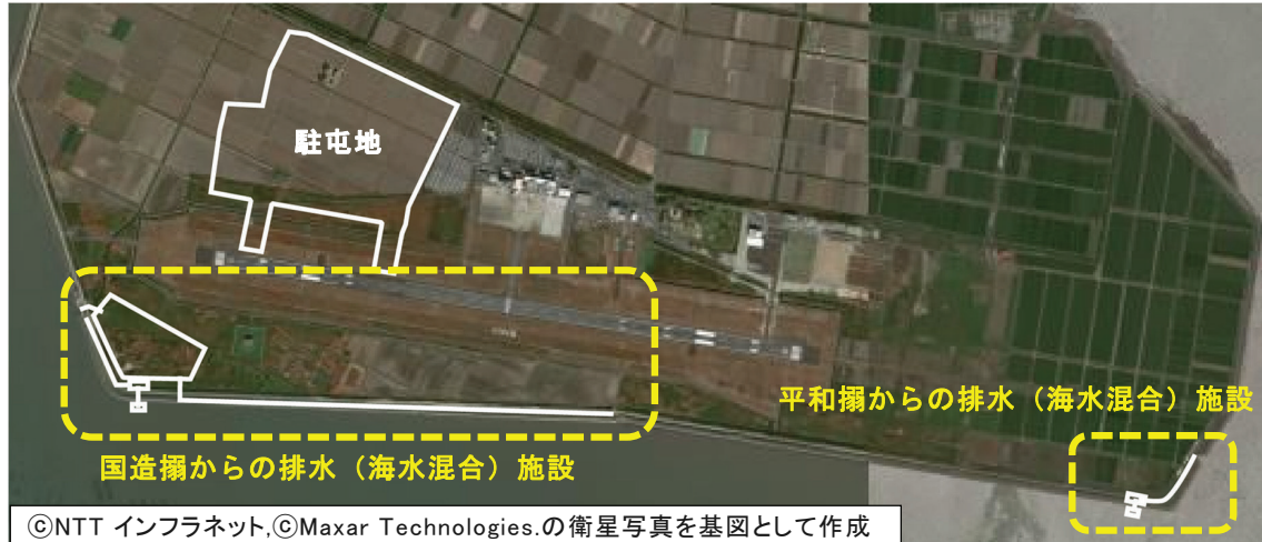
図 2.5-5 排水(海水混合)施設整備イメージ
