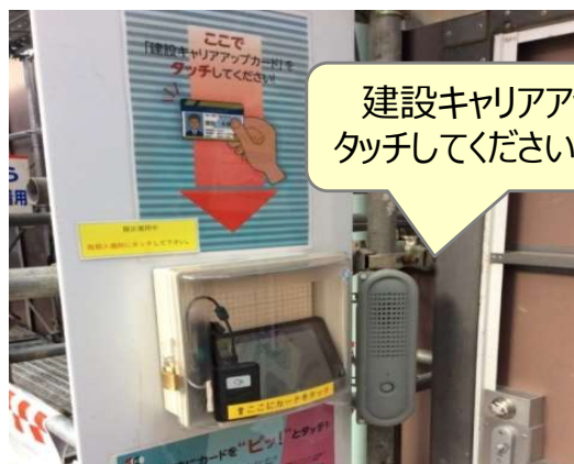
人感センサーによるスピーカーを設置して、技能者に自動呼びかけ
