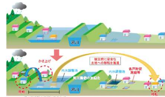
多層的な浸水被害対策(イメージ)
