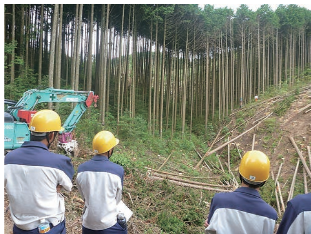
スイングヤーダによる集材作業
