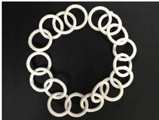
3Dプリンターで出力後、1300℃で焼成に成功したもの
