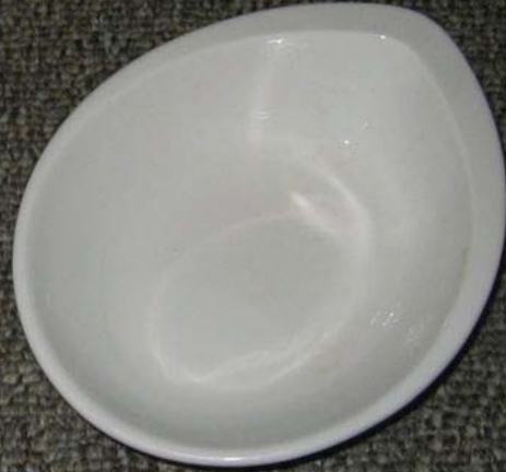
原型から型を作り、 成型・焼成したもの
