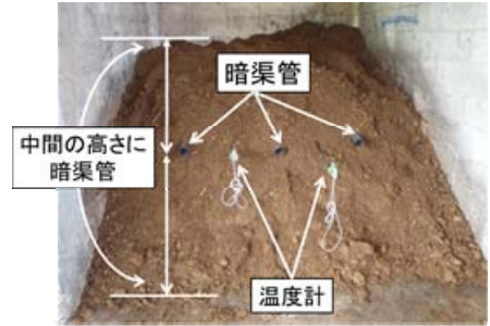
写真2 暗渠管の埋設状況
