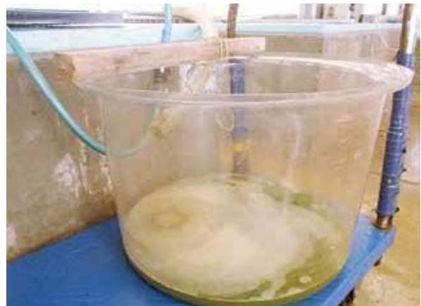
図版7-5 泡沫分離装置からの排水受け
