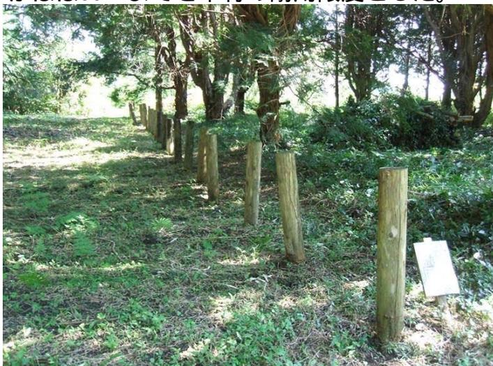
写真-1 野外暴露試験杭
