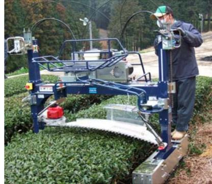
写真1 開発した自走式茶園管理機（左：軽トラック積載状態、右：茶園での作業状況）
