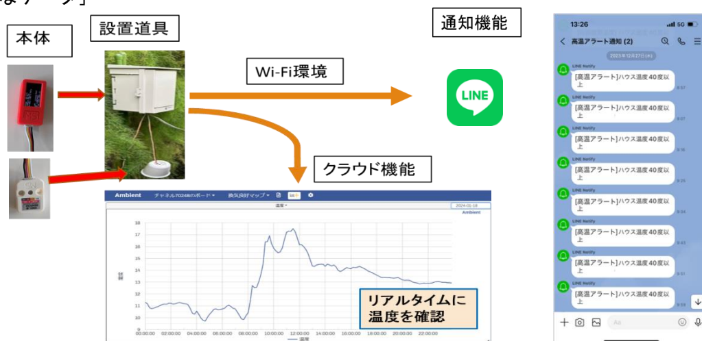
図1 自作した測定装置のイメージ図 (気温)
