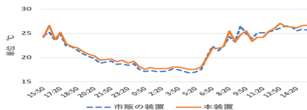
図2 市販の装置と本装置の比較 (ハウス内の気温)
