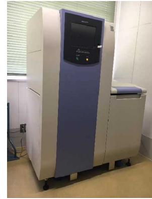
液体シンチレーションカウンタ （ \beta 線） トリチウムの測定に使用
