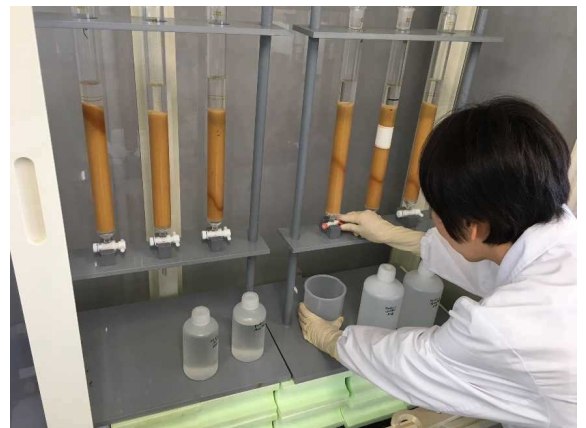
測りたい放射性物質のみを取り出す操作の 一例（ストロンチウム90分析）
