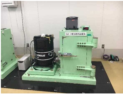
ゲルマニウム半導体検出器（ \gamma 線） ガンマ線の測定全般に使用
